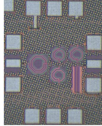
Fig. 2: Micrograph of 26GHz LNA
