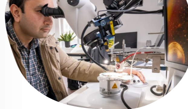
Hausinterner, hochmoderner Drahtbonder für Mikrochip-Bonding und -Verbindungen. In-house state-of-the-art wire bonder for microchip bonding and interconnections.
